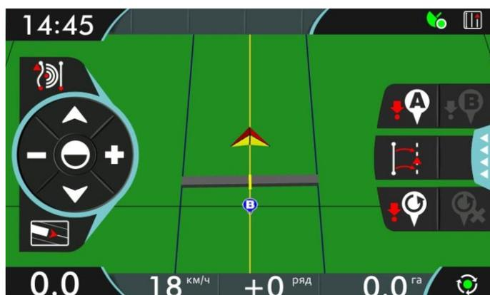
Когда обе точки установлены, устройство построит навигационную линию. Линия желтого цвета показывает центр ряда, линии синего цвета – края ряда. При развороте линия переносится на соседний ряд автоматически. Для построения новой линии, нажмите заново на кнопку «А», и повторите вышесказанное.
