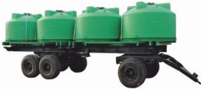
Расположение кассет на прицепе ПТС-12
