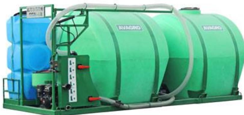
Комплекс предназначен для качественного приготовления различных растворов защиты растений и быстрого перекачивания их в емкость опрыскивателей, что существенно снижает время простоя техники и исключает воровство дорогостоящих хим. препаратов.
