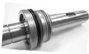
10. Не давите, а просто поместите компоновочный узел вала в корпус мотора, чтобы конец вала с резьбой был наверху. Перед сборкой смажьте два уплотнительных кольца гидравлическим или минеральным маслом.
