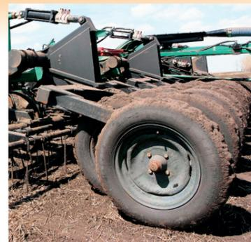
Пневматические колеса, попарно установленные на балансирах и сгруппированные в секции на задней части рамы посевного орудия, обеспечивают точное прикатывание полосы посева за каждым сошником. Междурядья остаются неприкатанными, что улучшает воздухообмен, уменьшает испарение влаги, препятствует развитию сорняков.
