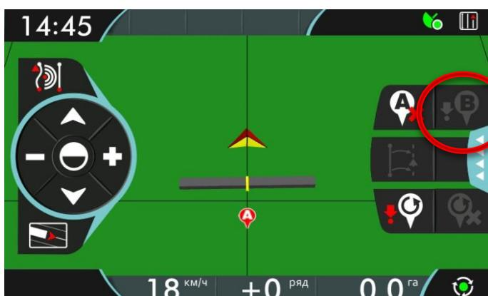
Далее, двигайтесь по прямой линии вдоль гона, и через 60 м на панели появиться кнопка «В», нажмите на нее .
