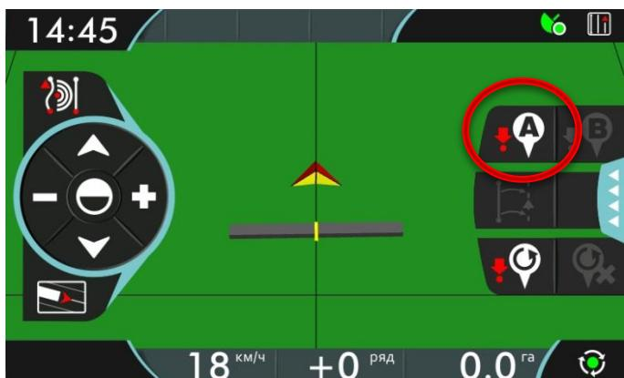
Установите машину перед началом гона. На панели справа нажмите кнопку «А» . Нажатие этой кнопки устанавливает точку А на поле.
